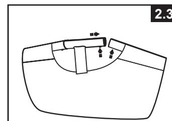
La conexión de la última articulación puede ser difícil de completar, pero se puede hacer fácilmente si al tiempo que sube esta última articulación más de 2 pulgadas (5cm), y se conecta la viga a la articulación de estas piezas al tiempo que vuelve a bajar a su posición normal. El travesaño se deslizará hasta quedar completamente anclado al codo (vea el dibujo 2.3). Asegurarse que el último codo este bien insertado antes de seguir con la instalación de las patas.
